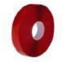
Nastro biadesivo in poliestere 230 $\mu$  adesivo permanente acrilico, ideale per la saldatura a freddo di ogni tipo di banner in pvc. Liner in propilene rosso.
